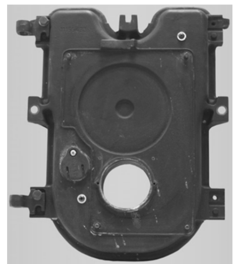
Abb./Fig. 2: Kesseltür nach erfolgter Brennerdemontage Porte de la chaudière après démontage du brûleur existant Porta della caldaia dopo lo smontaggio del bruciatore
