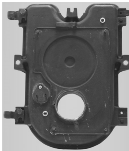
Abb./Fig. 2: Porte de la chaudière après démontage du brûleur existant Porta della caldaia dopo lo smontaggio del bruciatore
